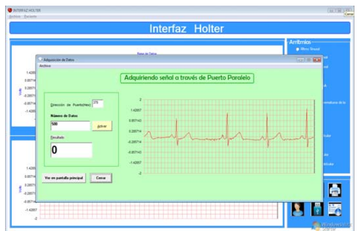
Fig. 15 a) Adquisición de datos por el puerto paralelo; b) Datos en pantalla principal para su análisis.
