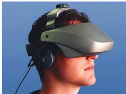
Figura 11. Sistema de despliegue basado en casco.
