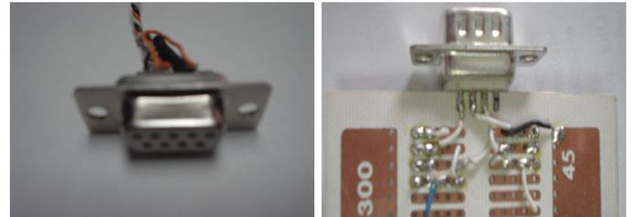
Figura 1. Cable Null-Modem de 3 hilos.
