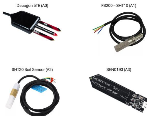
Fig. 6. Sensor de temperatura y humedad del suelo base y sus alternativas que cumplen con los criterios de selección
