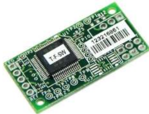
Fig. 13. Sensor ThinkGear ASIC Module v1.0 (TGAM1)
