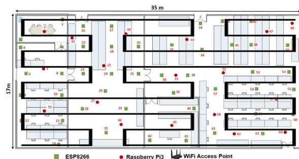
Fig. 9. Distribución de UMC en una planta convencional utilizando la curva fractal de Peano
