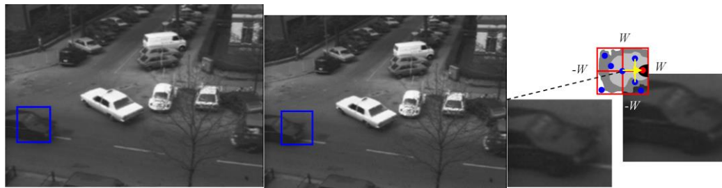
Fig. 10. Procedimiento de búsqueda del algoritmo de BA. Un conjunto de siete armonías son generadas aleatoriamente en el espacio de búsqueda S . Una de ellas se encuentra en el punto central [0,0]
