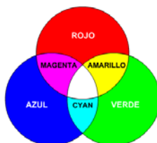
Fig. 2. Síntesis aditiva empleada por el modelo RGB
