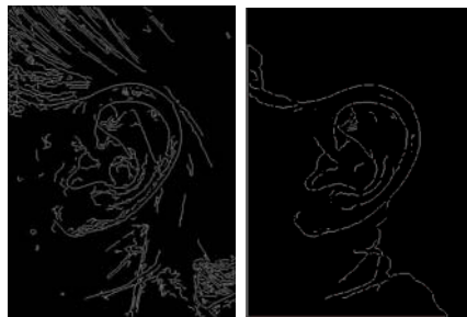
Fig. 10. Detección de bordes con Canny sobre la imagen original y sobre la imagen segmentada y tratada con el filtro Gaussiano
