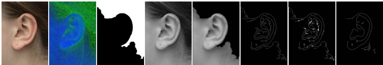
Fig. 12. Secuencia de imágenes resultantes mediante el algoritmo Ear-edges para la detección de los bordes de la oreja. La imagen en la extrema izquierda representa la entrada, y las siguientes imágenes corresponden a las salidas para los pasos 1 al 7
