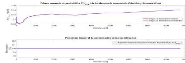
Fig. 29. Primer momento de probabilidad E\{\tau_{T_{x,k}}\} de los tiempos de transmisión para Telemetría
